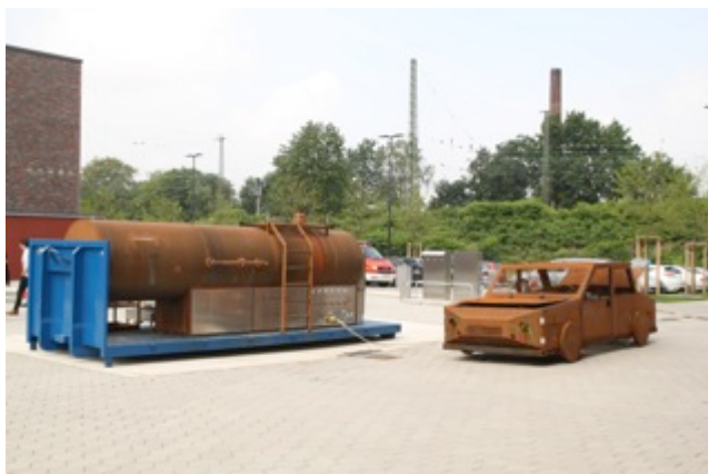
Auf dem Gelände der Feuerwache befinden sich Attrappen mit gasbefeueten Brandstellen für realitätsnahe Einsatzübungen
